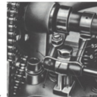
M121.921: Schwinghebel E / A unterschiedlich und auf Nebenwelle gelagert
