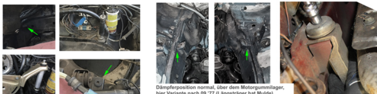
Dämpferposition bei Krümmerkat-Typen weiter vorn: an Anbauteilen des Motorstirndeckels sind Haltearme.
