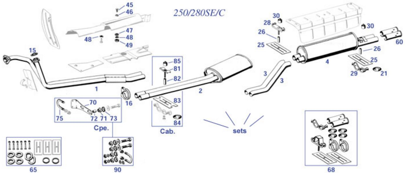
In dieser Abbildung: die zweiflutige Version (durchgängig Doppelrohr). Sie wurde ab Einspritzmodell 250SE W108 oder W111 und danach für alle 280S/SE als Modernisierung/Nachfolger der Einrohr-Anlage eingesetzt (Typen bis 250S), Da nicht mehr alle Teile aus Industrienachfertigungen erhältlich sind, kann Adaption sinnvoll sein:
