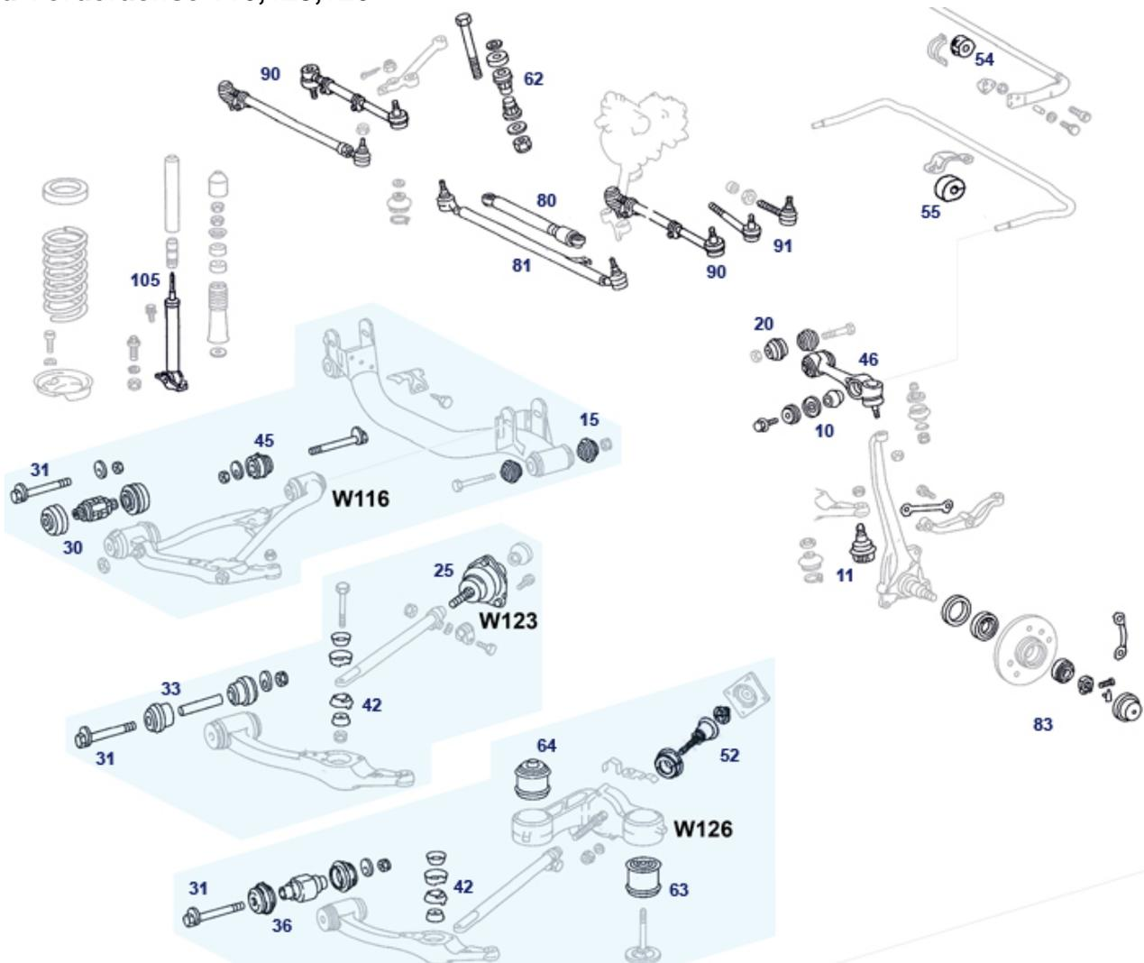
Typen mit oben montierten Stabilisator-Drehstäben, im Bild häufig gefragte Teile der Standardausführungen (Stahlgefedert). Bei Anfragen können Fahrzeugdetails relevant sein: ABS betrifft Umgebungsteile der Radnabe, für Federn-Dämpfer-Anfragen bitte sämtliche Daten (ggf. Datenkarte) oder Original-Vergleichsnummern beifügen.
